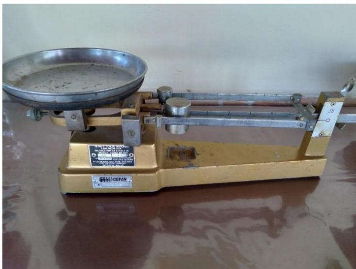
Figura 4 - Balança de precisão mecânica
