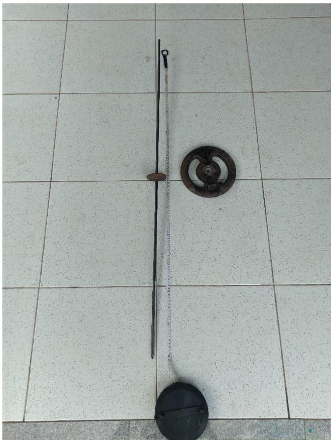
Figura 5 - Instrumento usado para testar resistência a penetração de raízes.
