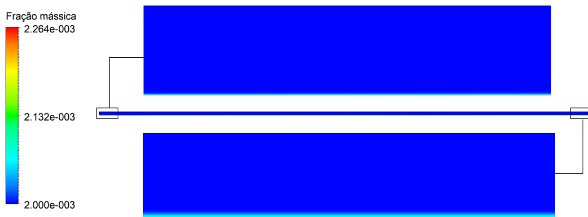
Figura 25 – Distribuição da fração mássica do soluto no canal de alimentação.
