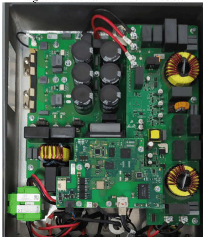
Figura 1 – Interior de um Inversor solar.
