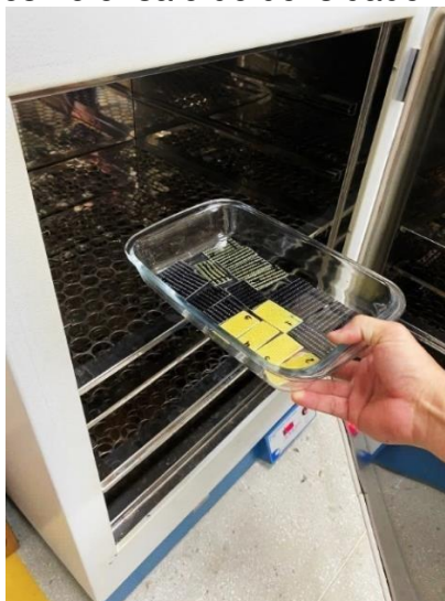
Figura 19 - CPs utilizados no ensaio de densidade indo para a estufa.
