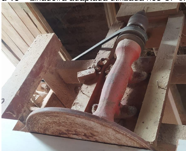
Figura 15 – Lixadeira adaptada utilizada nos CP's.
