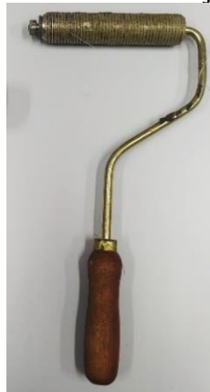
Figura 11 – Rolo utilizado na laminação das placas.
