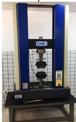
Figura 17 - Máquina utilizada para o ensaio de tração.
