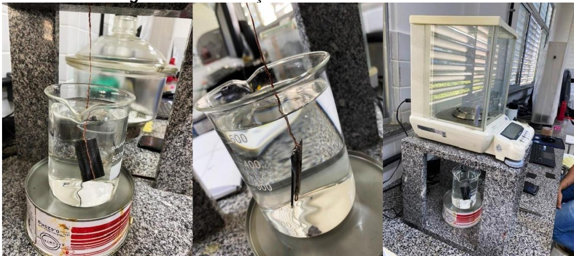
Figura 21 - Realização do ensaio de densidade.
