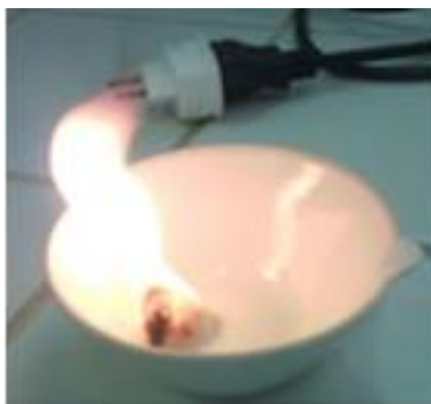
Figura 13 - Teste de combustão do biodiesel proveniente do óleo residual
