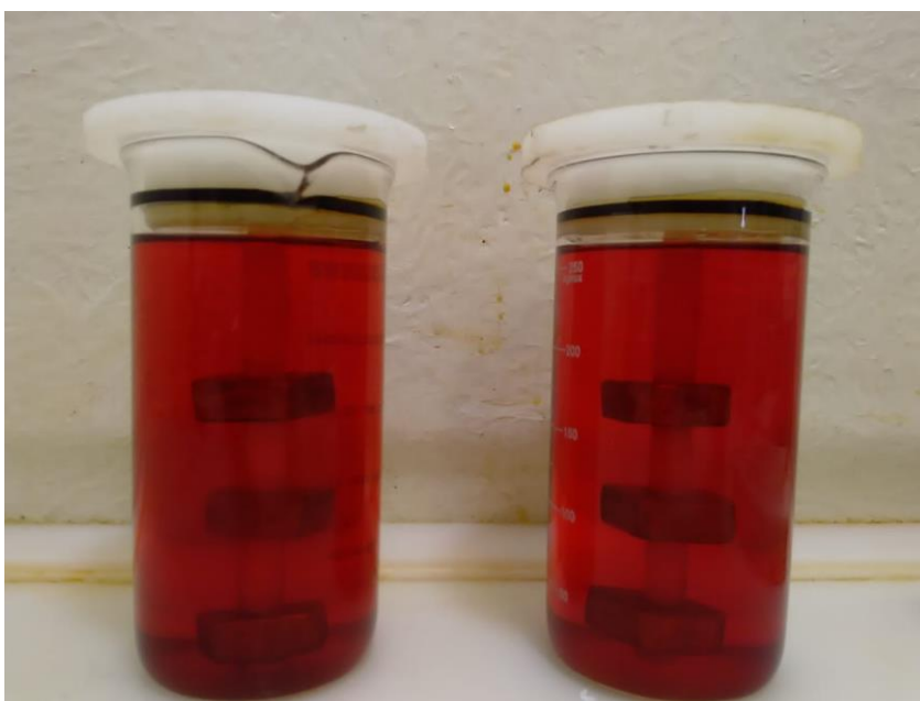
Figura 11 – Corpos de prova de cobre em mistura diesel/biodiesel em ensaio gravimétrico
