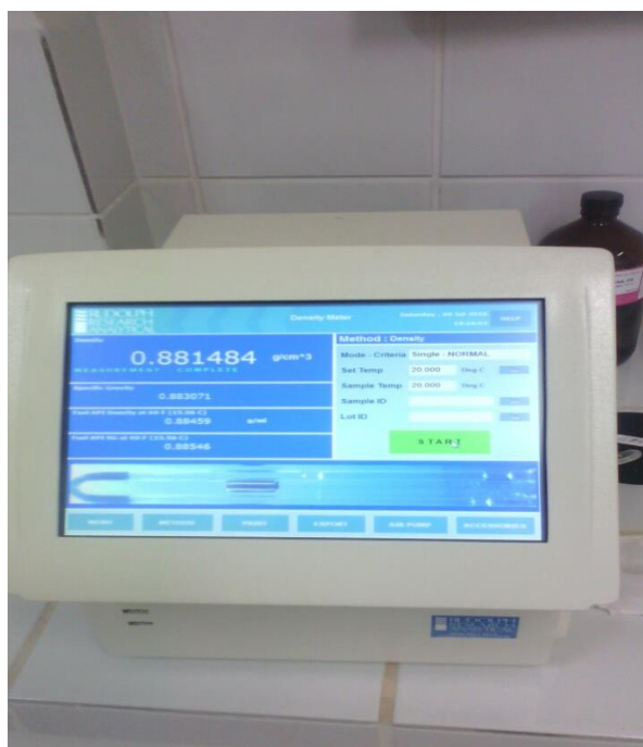
Figura 7 - Densímetro digital da marca Rudolph Research Analytical
