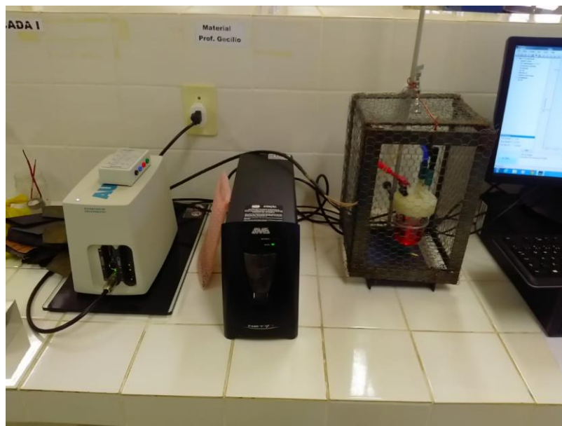
Figura 3 – Potenciostado montado à célula de ensaio de polarização
