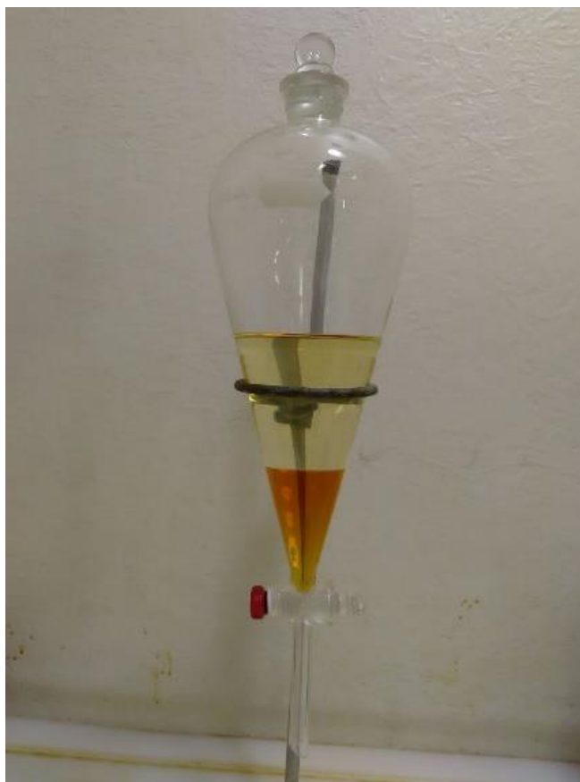
Figura 1 - Produção do biodiesel pela técnica de transesterificação
