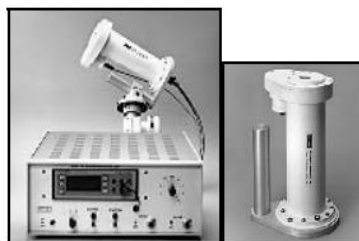
Figura 11: Pireliômetros de Cavidade Absoluta
