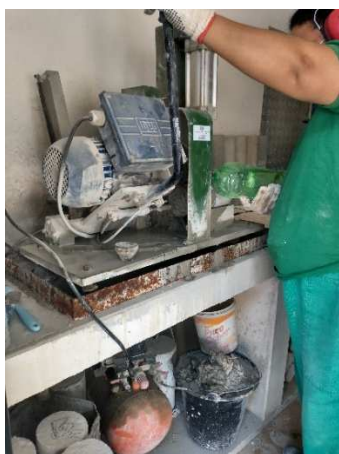
Figura 05: Retífica dos corpos de prova. (autoria própria)
