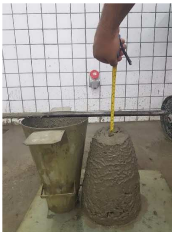
Figura 02: Ensaio de abatimento de slump. (autoria própria)
