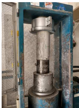
Figura 06: Ruptura dos corpos de prova. (autoria própria)
