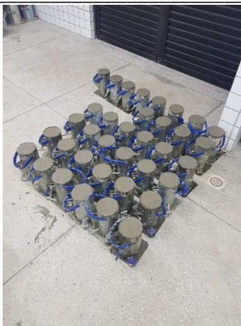
Figura 01: Moldagem dos corpos de prova. (autoria própria)
