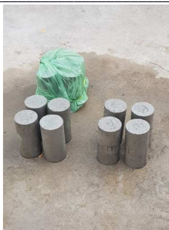
Figura 04: Cura por irrigação exposto a intempéries. (autoria própria)
