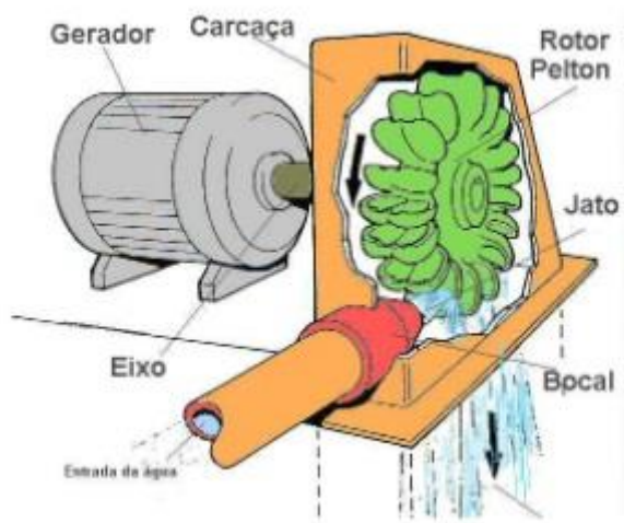
Figura 4: Turbina Pelton Fonte: Meu site Mackenzie
