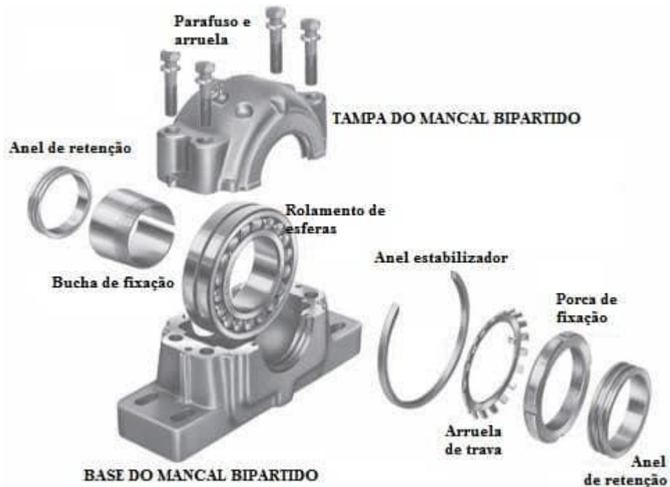
Figura 7: Ilustração de partes de um mancal bipartido.
