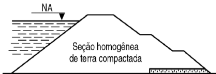
Figura 6- Barragem homogênea. Fonte: (CAPUTO, 2017, p. 517)
