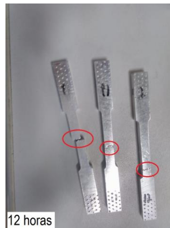
Figura 21: Corpos rompidos logo após o ensaio de tração
