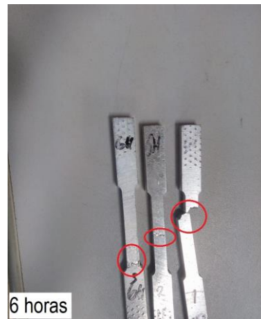
Figura 20: Corpos rompidos logo após o ensaio de tração
