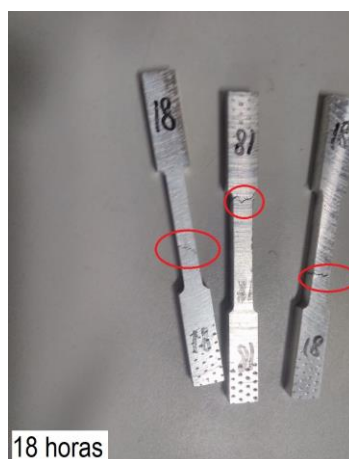
Figura 22: Corpos rompidos logo após o ensaio de tração
