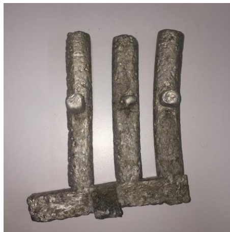
Figura 11: Material usinado e recozido á 12 horas
