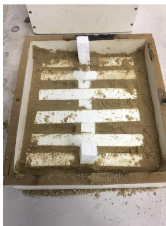
Figura 9: Caixa de madeira para fixação do molde de isopor
