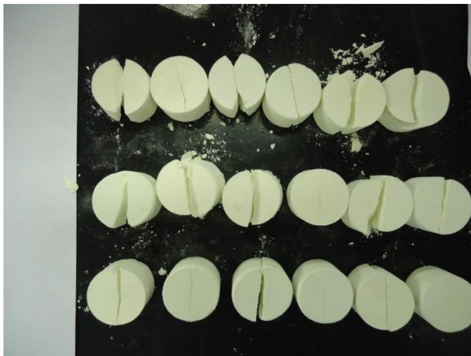
Figura 32: Corpos-de-prova fraturados após os ensaios de compressão diametral.
