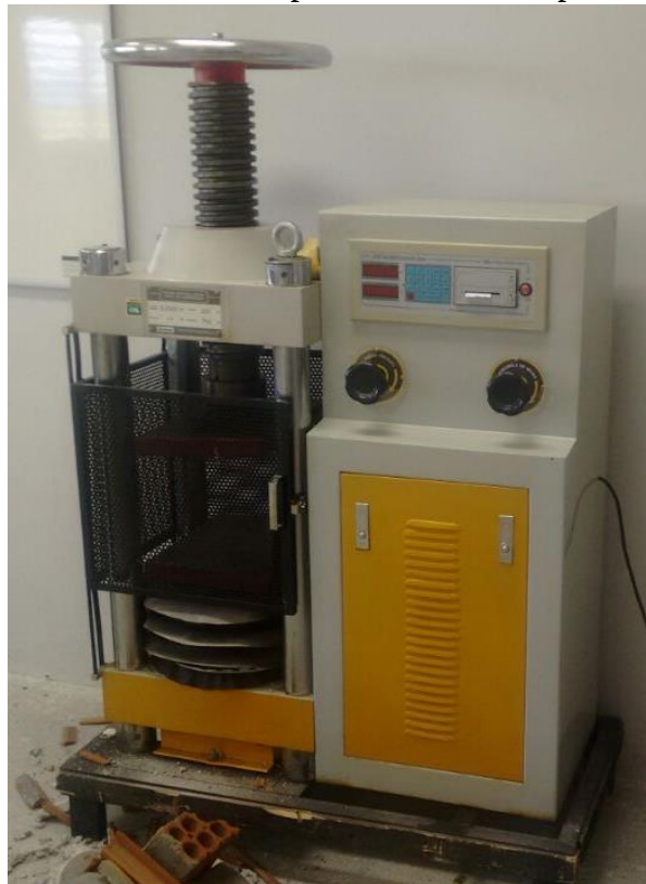
Figura 18: Prensa utilizada para ensaio de compressão
