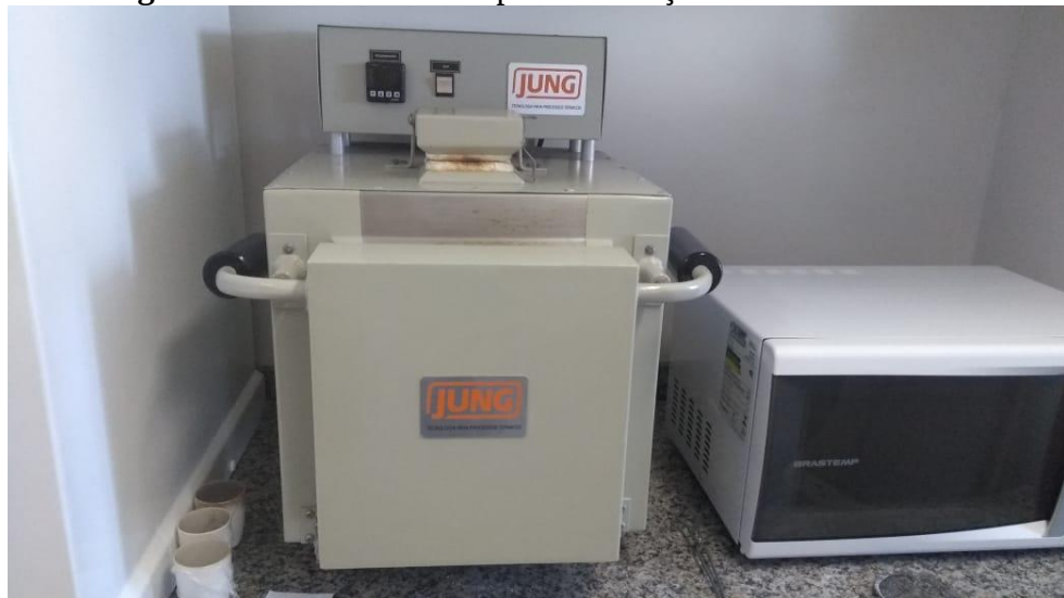
Figura 13: Mufla utilizada para calcinação do resíduo
