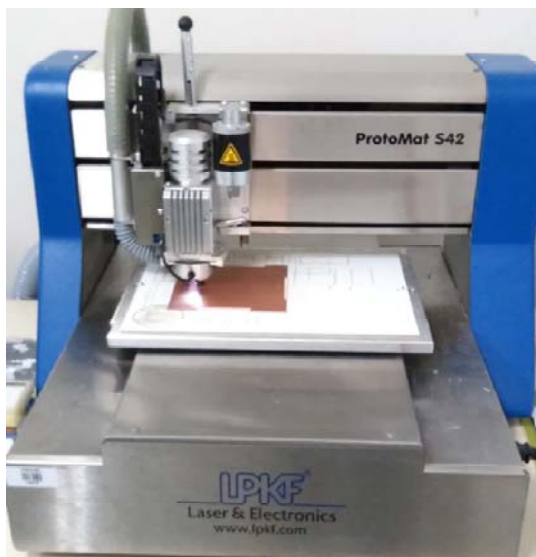
Figura 43: Fresa de prototipagem utilizada na fabricação das antenas. Fonte: Autoria Própria, 2016.
