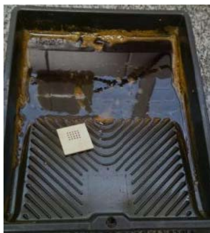
Figura 49: Processo de corrosão das estruturas utilizando Percloreto de Ferro ( \text{FeCl}_3 ).
