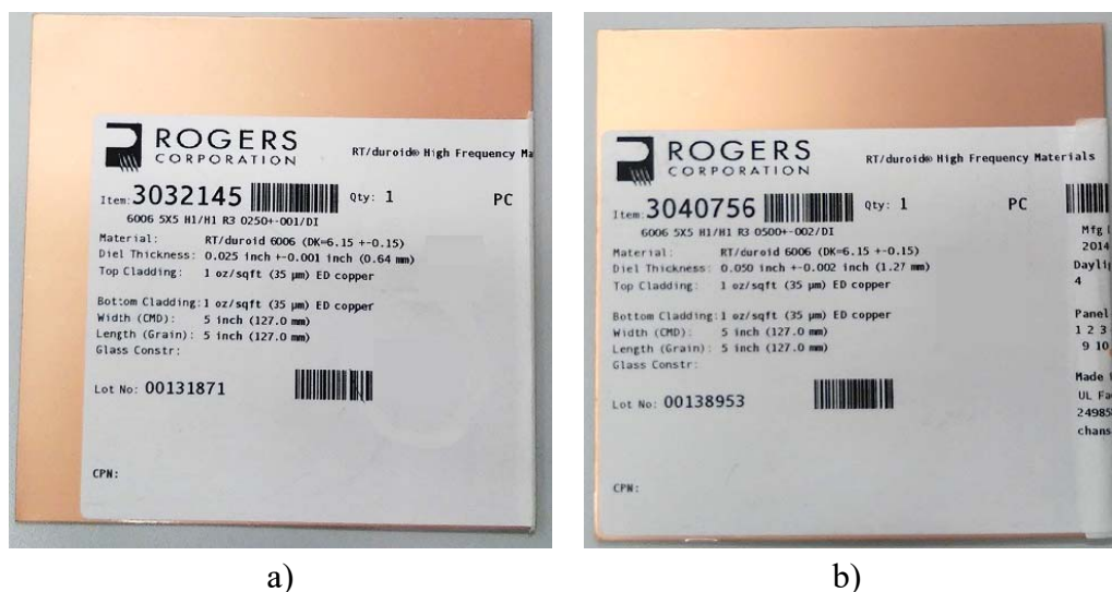
Figura 40: Dielétricos utilizados para fabricação das antenas com substrato de RT/Duroid 6006 de alturas a) h=0,64 mm b) h=1,27 mm.
