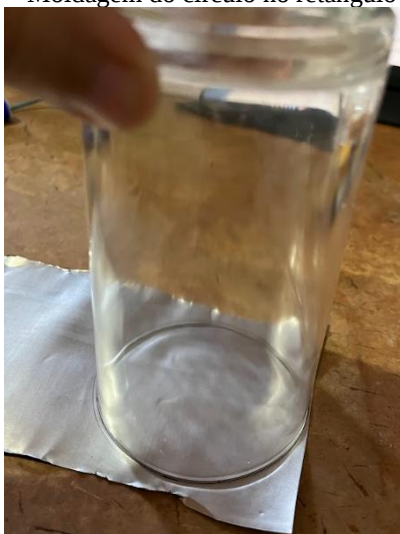
Figura 32 – Moldagem do círculo no retângulo de latinha.
