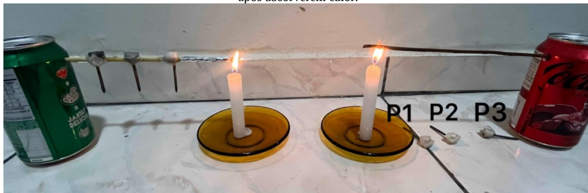
Figura 44 – O papel alumínio queimado na extremidade do palito de madeira e os pregos do fio de cobre caídos após absorverem calor.
