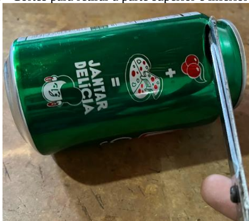
Figura 31 - Cortes para retirar a parte superior e inferior da latinha.
