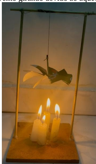
Figura 45 - Catavento girando devido ao aquecimento das velas.
