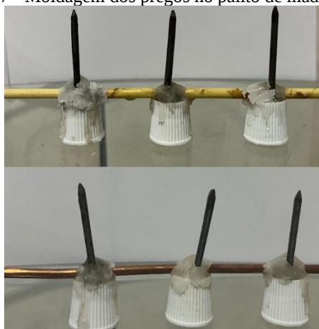
Figura 27 - Moldagem dos pregos no palito de madeira e fio de cobre.
