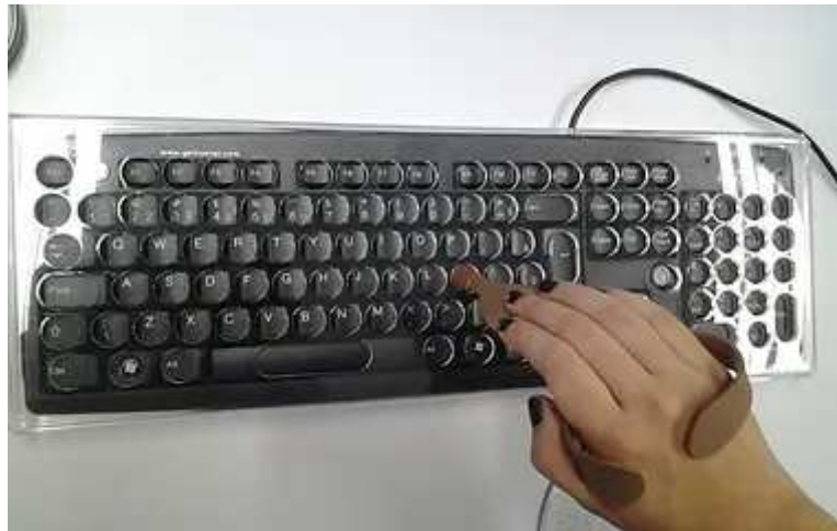
Figura 3 - Teclado adaptado para pessoas com dificuldades motoras.
