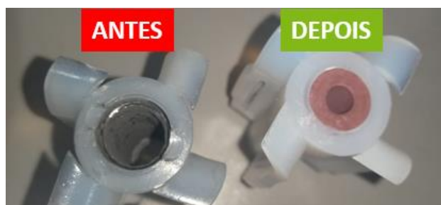
Figura 13 - Uso de bucha teflonada na bomba do peróxido CFAs (Autoria própria, 2021).
