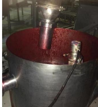
Figura 10 – Sensor de volume no tanque da prensa (Autoria própria, 2021).
