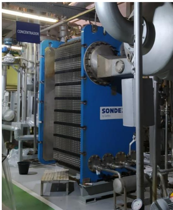
Figura 4 - Trocador de calor por placas utilizado no processo de concentração (Autoria própria, 2021).
