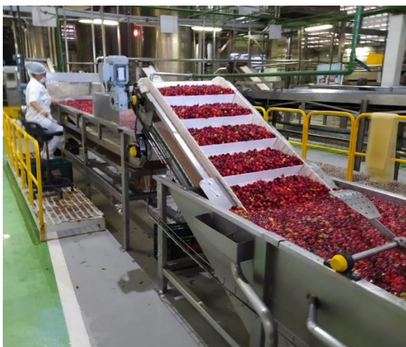
Figura 2 – Esteira de lavagem no processamento da acerola madura (Autoria própria, 2021).
