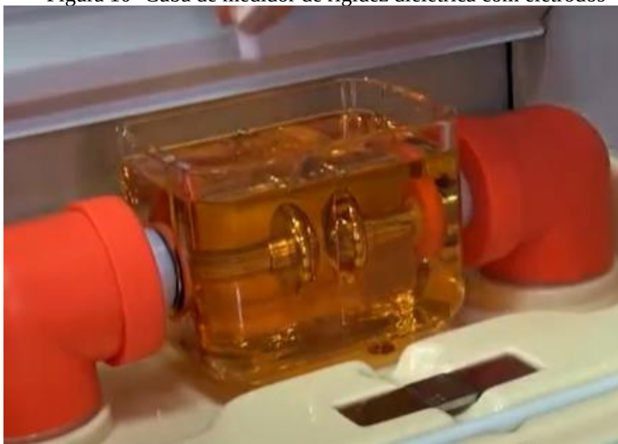
Figura 10- Cuba de medidor de rigidez dielétrica com eletrodos
