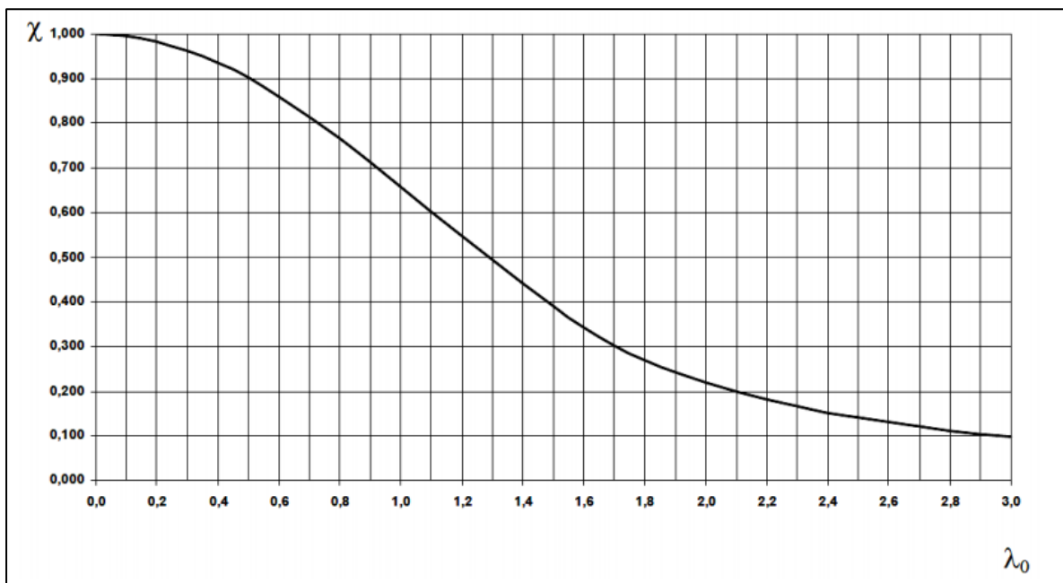
Figura 8 - Gráfico do fator de redução em função do índice de esbeltez reduzido
