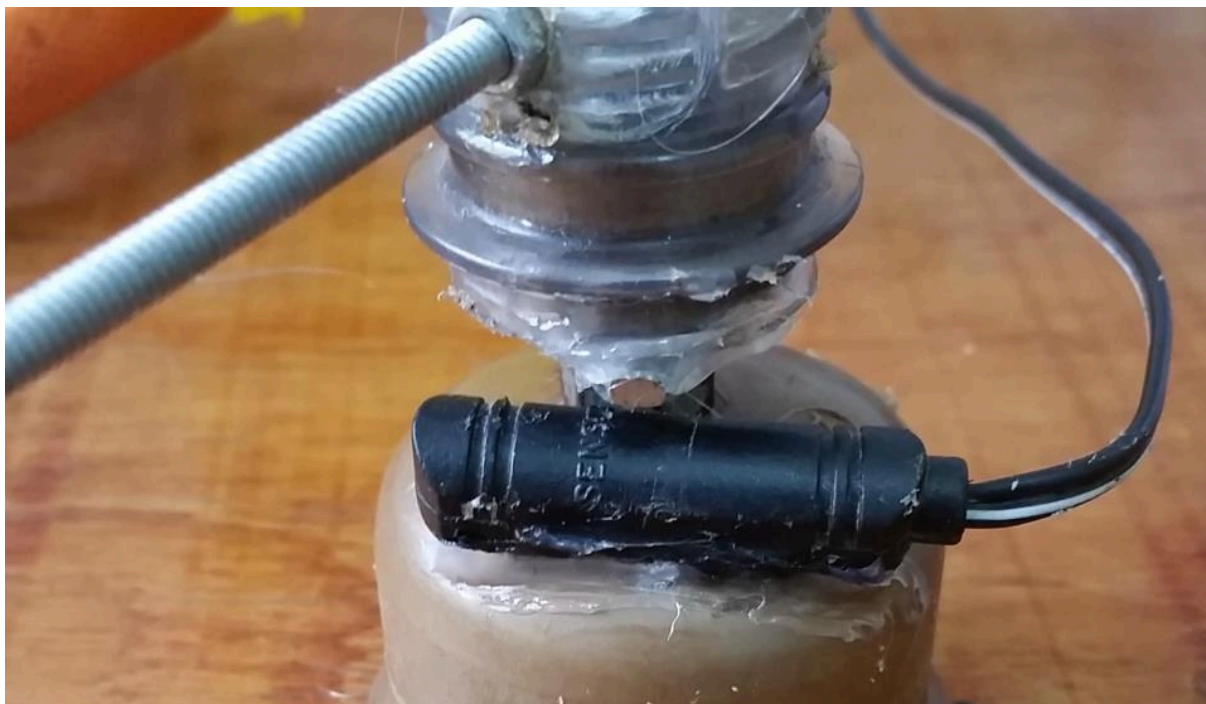
Figura 12 – Sensor magnético e ímãs de neodímio no anemômetro.
