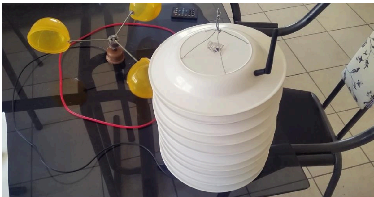
Figura 44 – Resultado do abrigo com sensores, controlador e transmissor.
