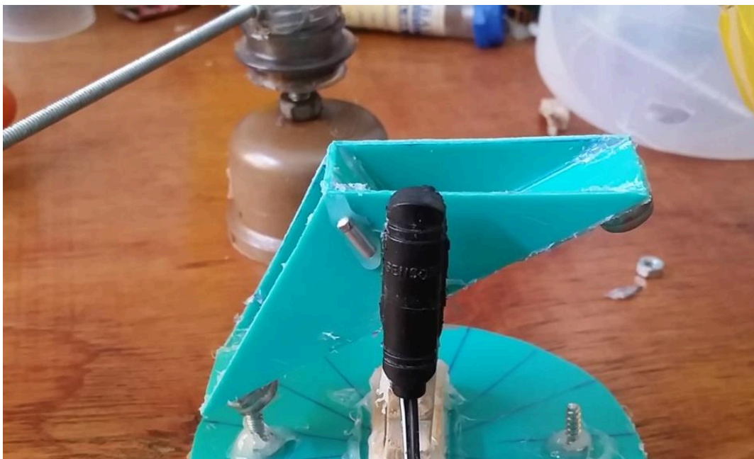
Figura 20 – Caçamba e base com sensor magnético e ímã.
