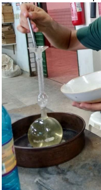
Figura 03 – Execução do ensaio de massa específica do cimento.
