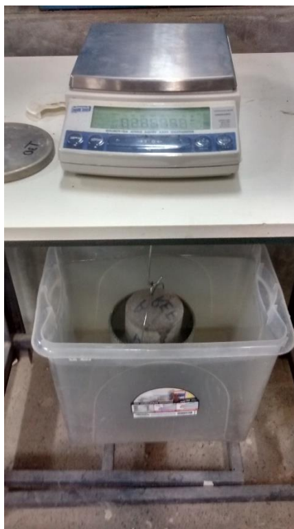
Figura 09 – Corpo de prova na balança hidrostática
