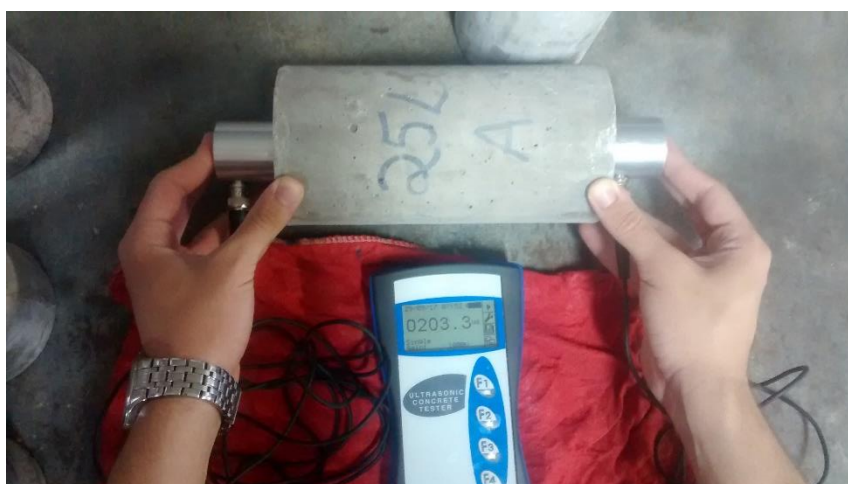
Figura 10 – Posicionamento do corpo de prova no aparelho de ultrassom.
