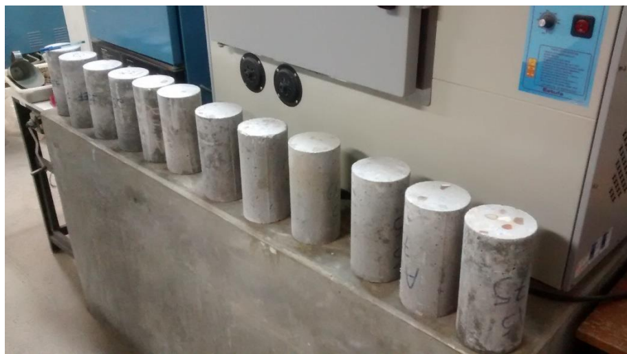
Figura 11 – Corpos de prova preparados para serem pesados na balança hidrostática.
