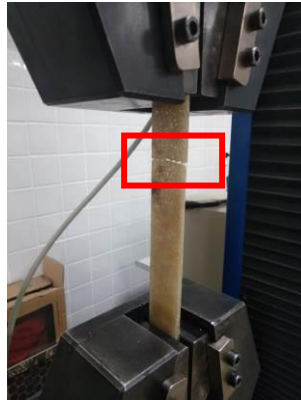
Figura 31 - Corpo de prova tracionado até a fratura.
