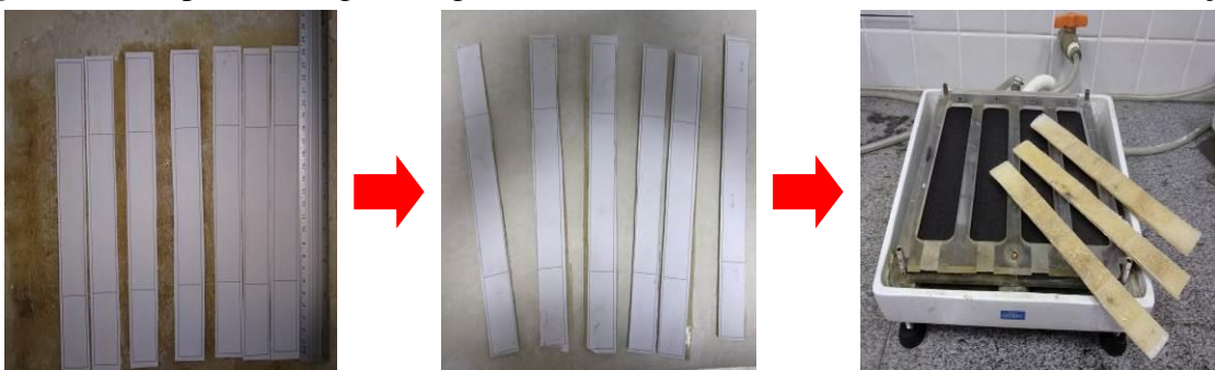
Figura 28 - Etapas de colagem do gabarito, corte e acabamento final das amostras de tração.
