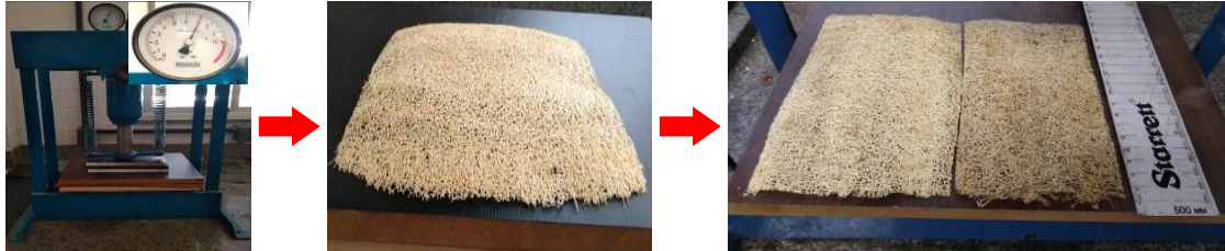
Figura 18 - Processo de prensagem e corte da manda.
