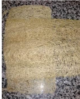
Figura 20 - Configuração e organização da manta utilizada como reforço no compósito.
