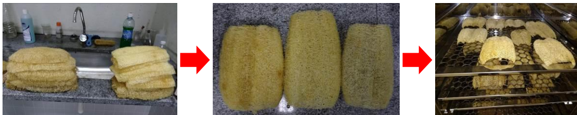
Figura 17 - Processo de lavagem e secagem da manta.
