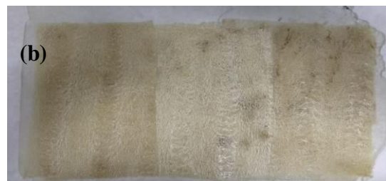
Figura 23 - Compósito fabricado. (a) Placa com dimensões de 30 x 30 cm; (b) Placa com dimensões de 30 x 20 cm.
