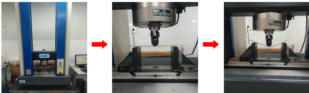
Figura 33 - Etapas do ensaio de flexão em 3 pontos.
