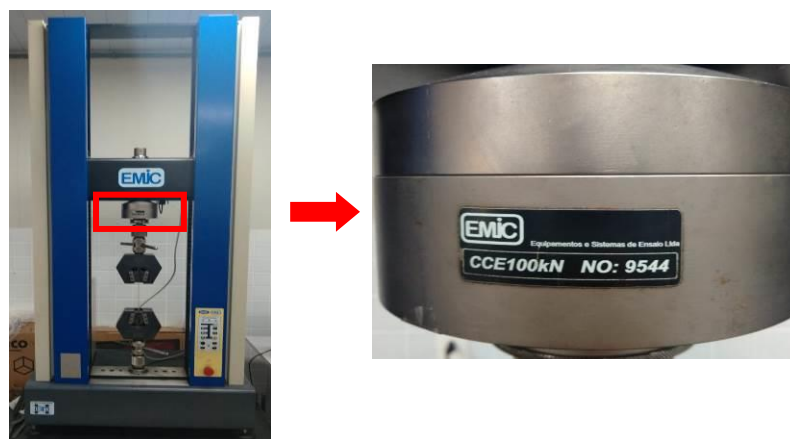
Figura 30 - Máquina de ensaio universal.
