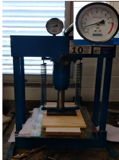
Figura 22 - Molde com o material compósito posicionado na prensa hidráulica.
