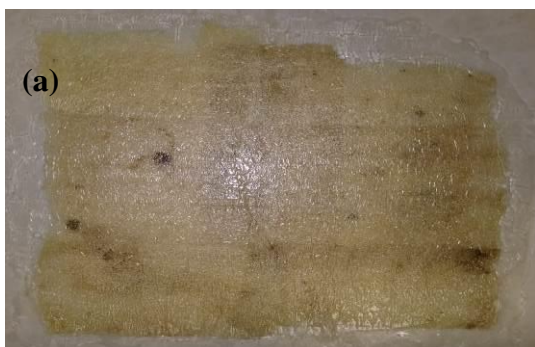
Figura 23 - Compósito fabricado. (a) Placa com dimensões de 30 x 30 cm; (b) Placa com dimensões de 30 x 20 cm.
