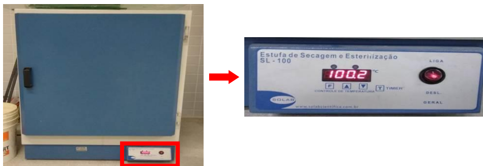
Figura 25 - Estufa com as amostras a temperatura de aproximadamente 100°C.
