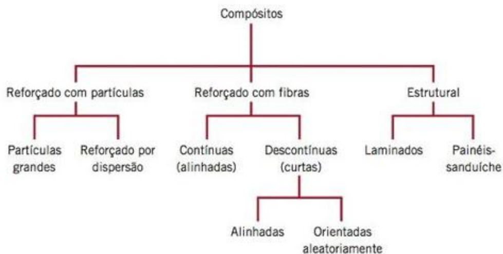
Figura 1 - Esquema para classificação de vários tipos de compósitos.
