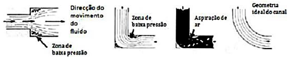
Figura 10: Formas de minimizar os efeitos da inércia em moldes.
