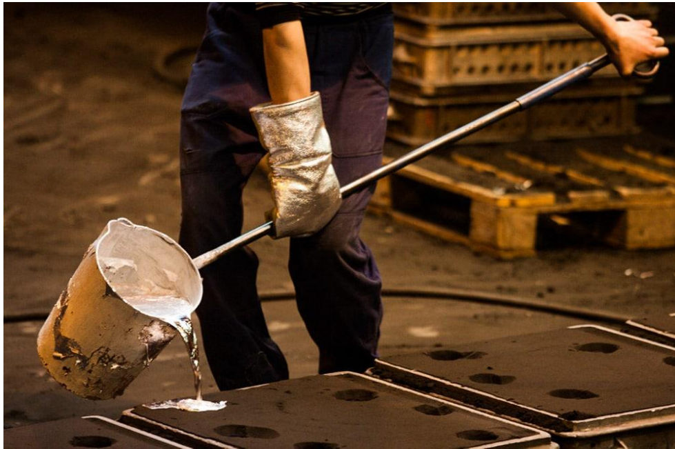
Figura 2: Fundição de liga de alumínio em molde de areia.
