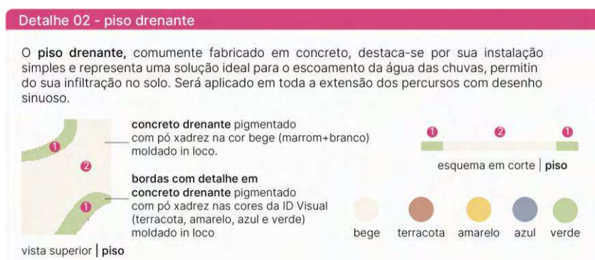
Figura 188 – detalhe do piso de concreto drenante
