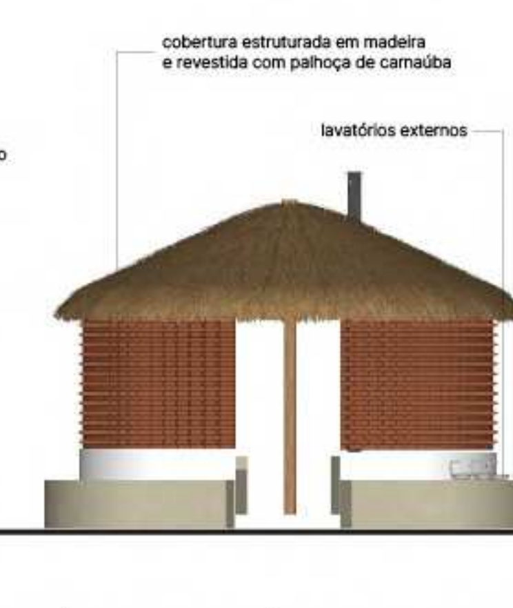
10 | fachada frontal | cozinha experimental esc: 1/75
