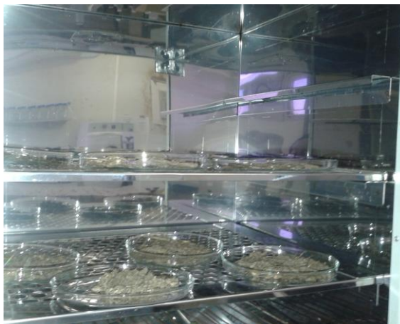
Figura 16 – Monitoramento da umidade conforme método de Lanarv.
