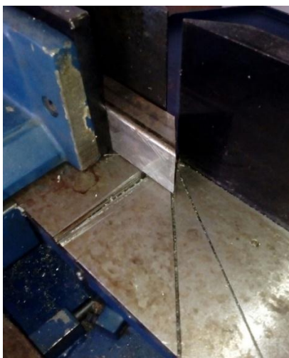
Figura 24 - Tubo de seção retangular no processo de corte
