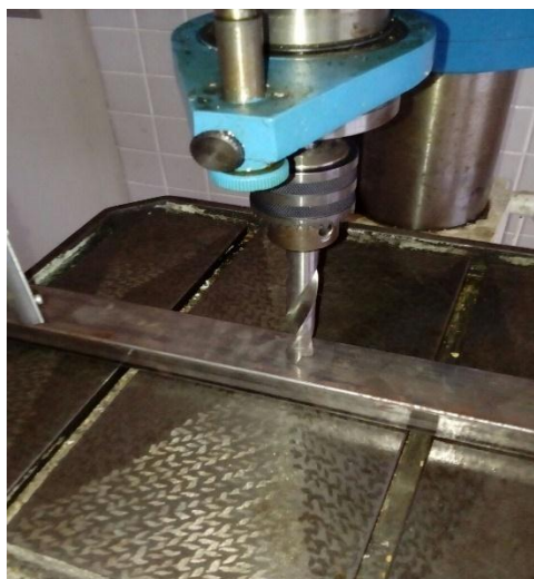
Figura 27 - Tubo de seção retangular superior no processo de perfuração
