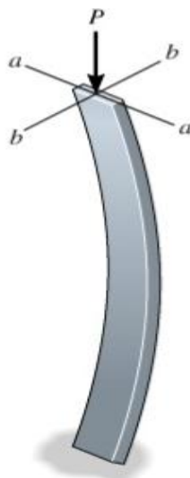
Figura 1- Flambagem em torno do eixo mais fraco
