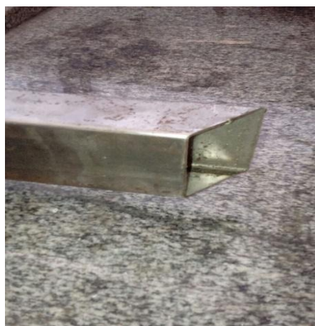
Figura 26 - Corte no tubo de seção retangular 50 x 30 mm de 45°
