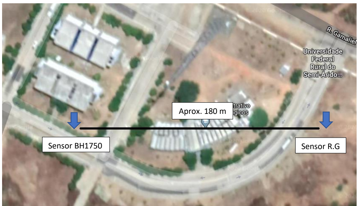
Figura 11: imagem de satélite que mostra a localização do sensor BH1750, do sensor de Radiação Global (R.G) e a distância aproximada entre os mesmos
