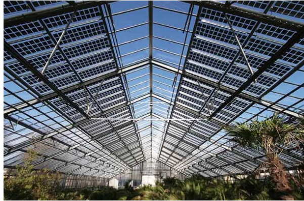
Figura 1: Projeto de Telhado Solar.
