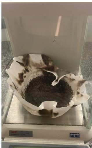
Figura 10 - Determinação do teor de lignina insolúvel
