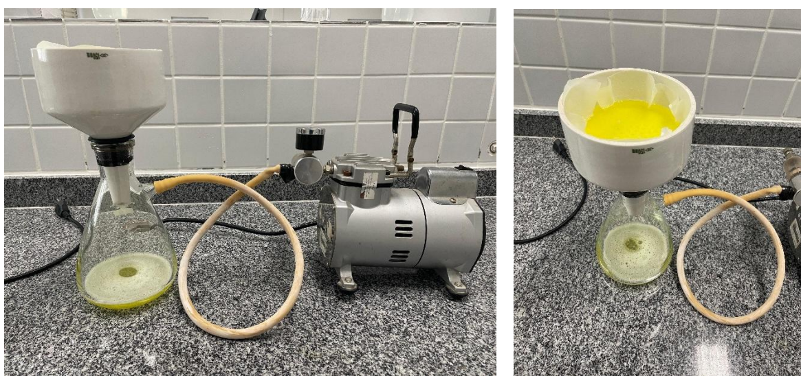
Figura 12 - Sistema de filtração a vácuo da holocelulose
