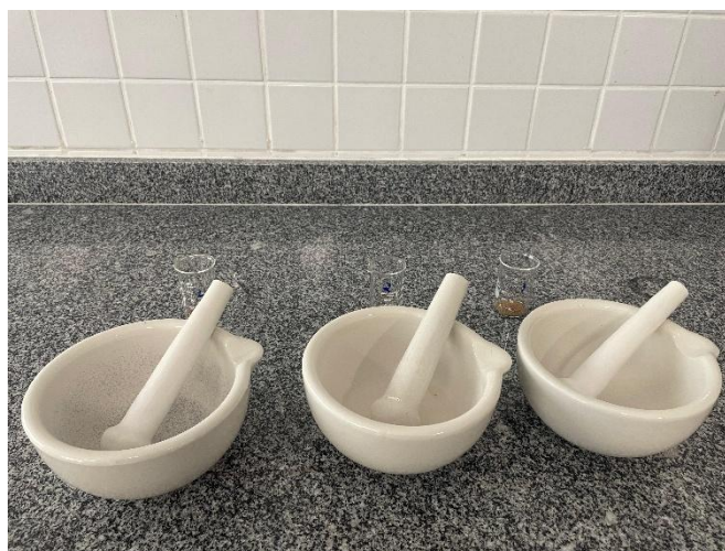
Figura 9 - Preparação da amostra para análise de lignina
