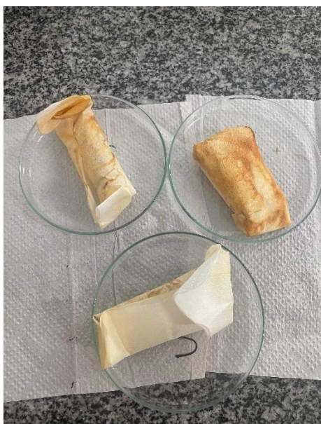
Figura 8 - Cartuchos de papel filtro contendo a amostra vegetal após extração
