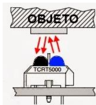
Figura 20 – Sensor Óptico Reflexivo TCRT5000
