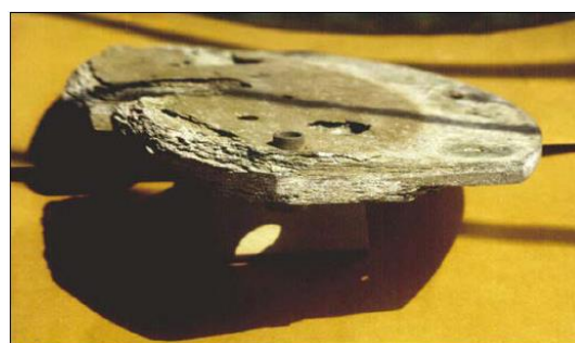
Figura 9: Esfoliação em liga de alumínio
