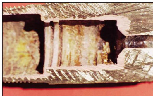
Figura 12: Corrosão por dezincificação em parte interna de uma válvula de latão
