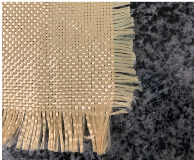
Figura 5 - Tecido de fibra de Aramida
