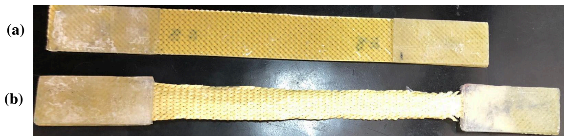
Figura 18 - (a) corpo de prova antes do ensaio x (b) corpo de prova pós ensaio
