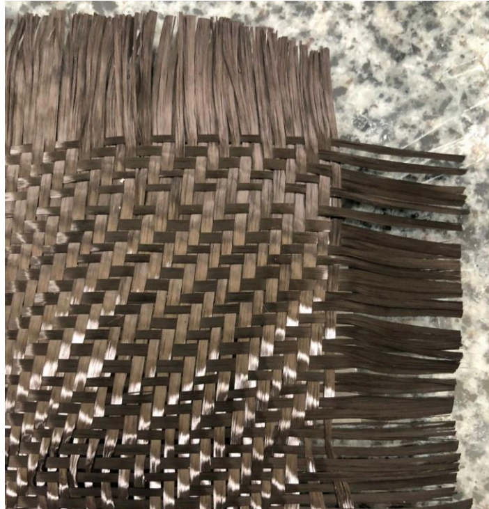
Figura 4 - Tecido de fibra de Carbono
