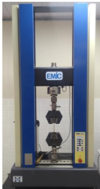
Figura 13 - Máquina utilizada para a realização do ensaio de tração uniaxial.
