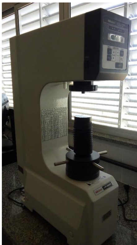
Figura 13 – Durômetro do Laboratório de Ensaios e Metalografia da UFERSA – Caraúbas
