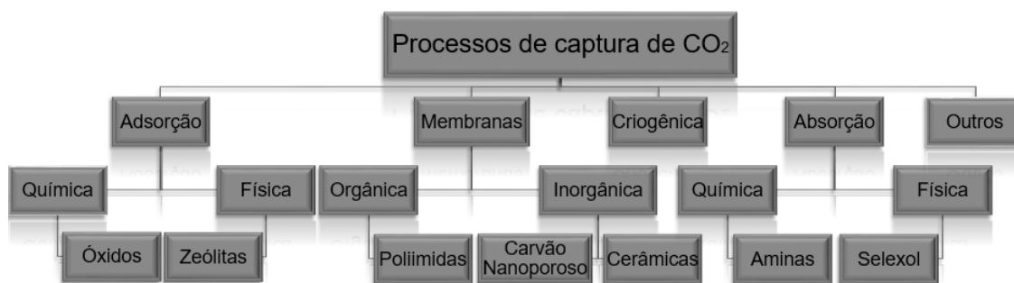
Figura 4 – Fluxograma dos métodos de separação do CO 2
