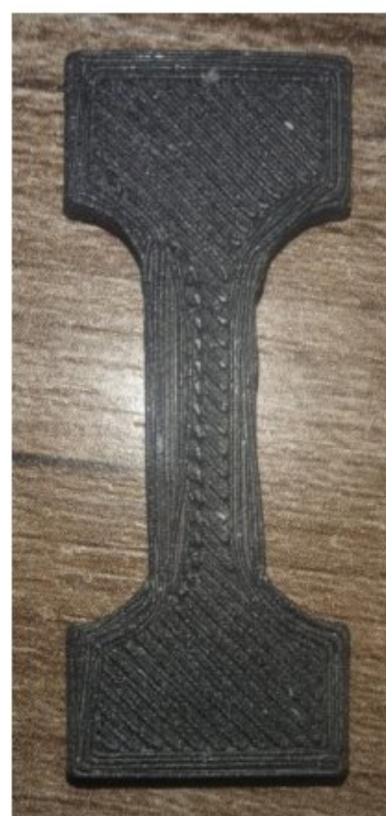
Figura 12: Corpo de Prova de Microtração texturizado.
