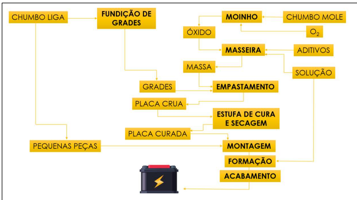
Figura 2: Processo de Produção de Baterias Chumbo-Ácido
