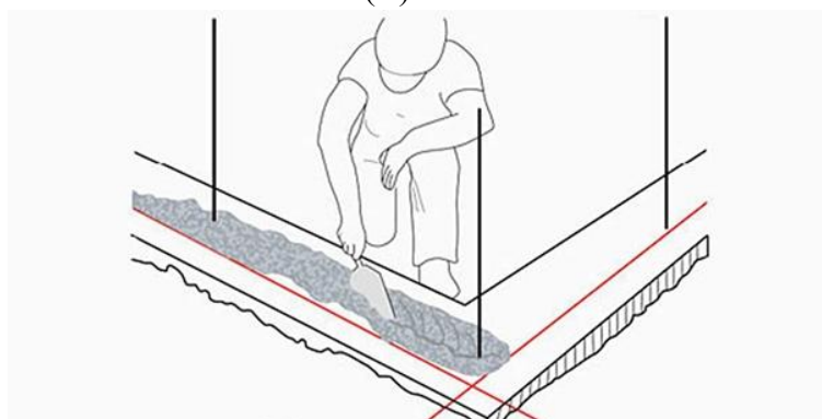
Fig. 3: Colocação da argamassa da primeira fiada sobre a laje ou viga baldrame
