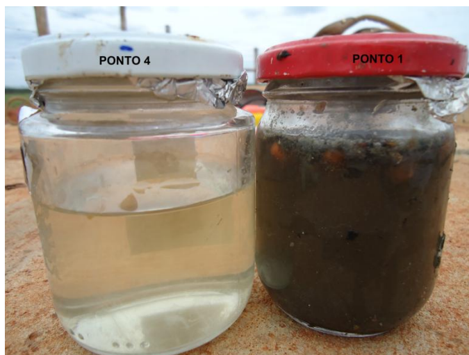
Figura 15. Ilustração dos efluentes coletados nos pontos 1 e 4 do sistema de tratamento do esgoto doméstico.
