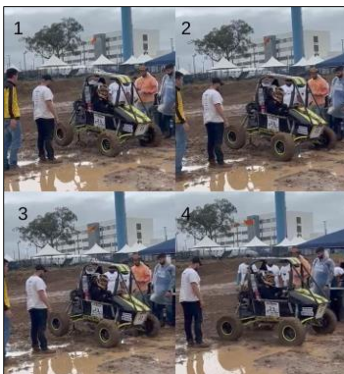
Figura 25- Frame do teste de funcionalidade da transmissão 4x4, no Nacional 2024.
