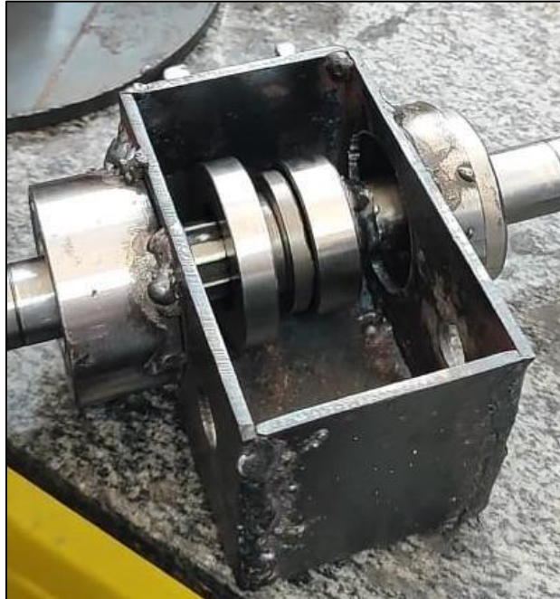
Figura 21- Caixa com os mancais soldados.
