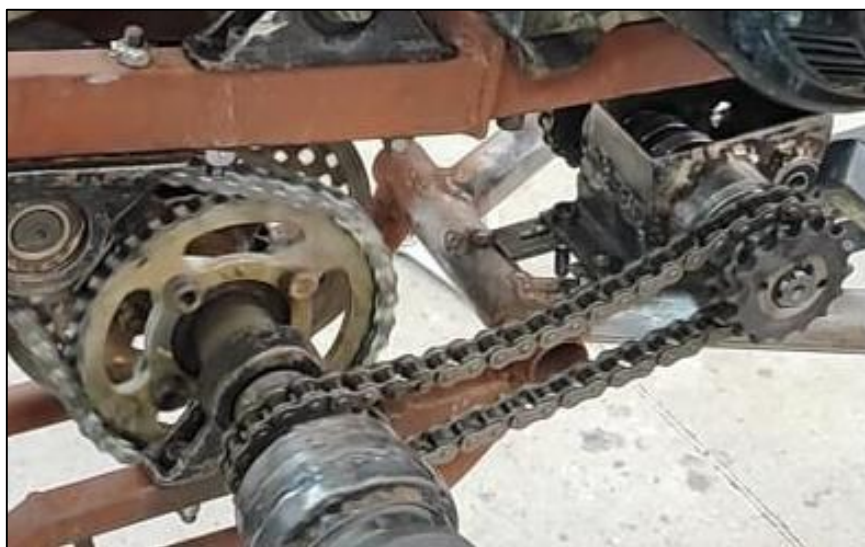
Figura 24- Caixa de acoplamento instalada no protótipo.
