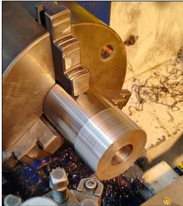
Figura 20- Usinagem dos mancais.
