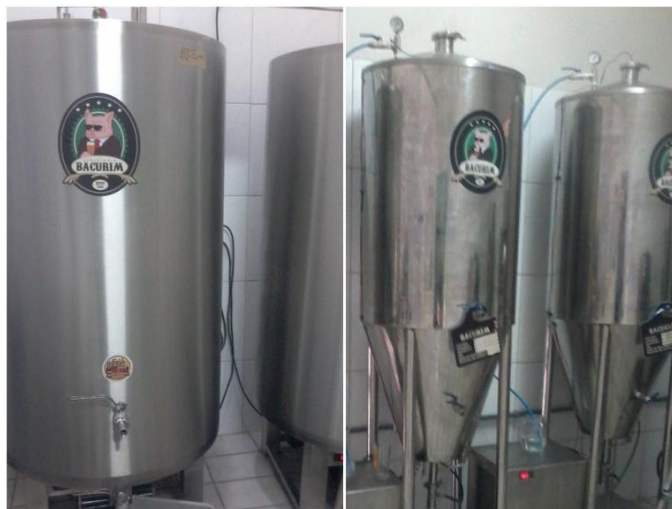
Figura 9: Detalhe dos tanques de fermentação
