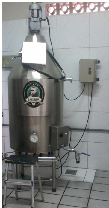
Figura 7: Tanque de fervura que funciona por meio de chama direta
