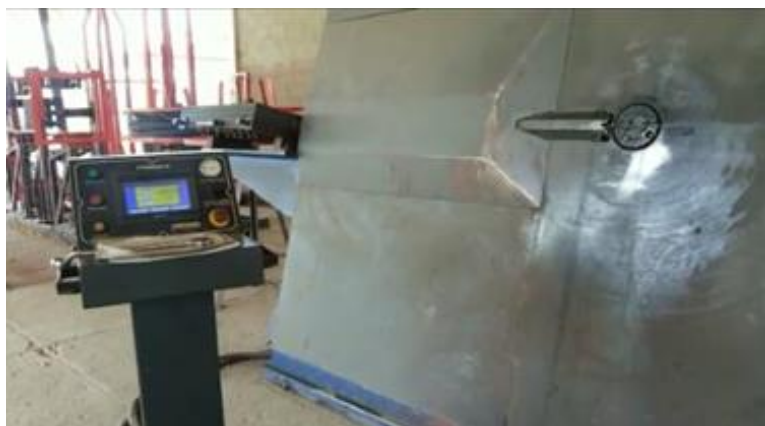
Figura 2. Painel do software de comando numérico da máquina de dobrar e cortar estribos. Fonte: Autoria própria
