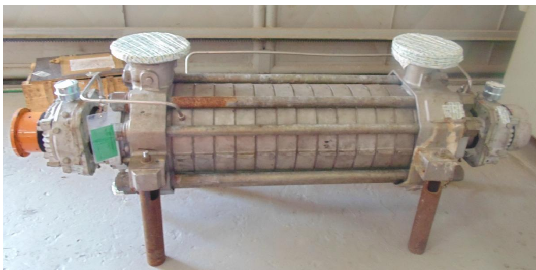
Figura 17: Bomba de múltiplos estágios na posição normal de operação
