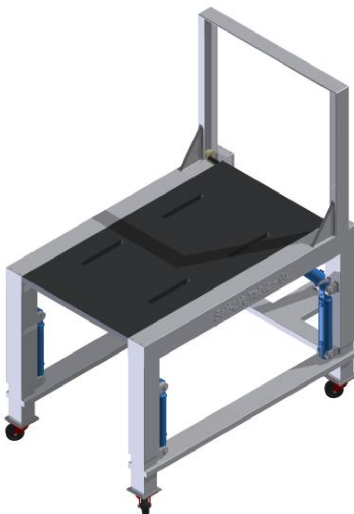
Figura 41: Bancada Hidráulica de movimentação de bombas
