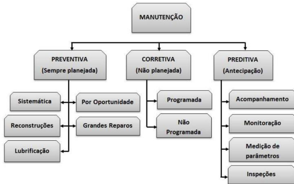
Figura 1: Principais tipos de manutenção e suas principais características
