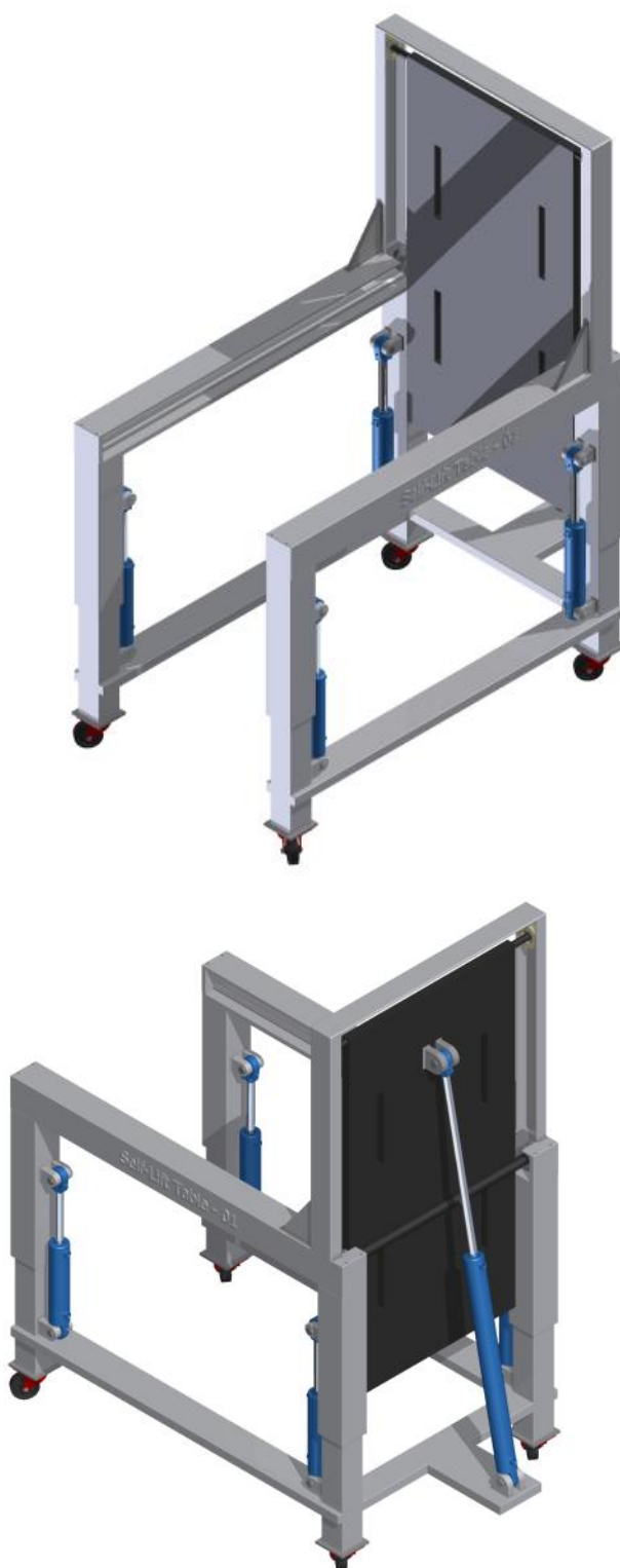
Figura 42: Bancada Hidráulica de movimentação de bombas acionada
