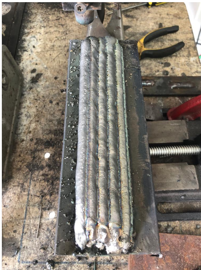
Figura 16 : Chapa após solda de amanteigamento
