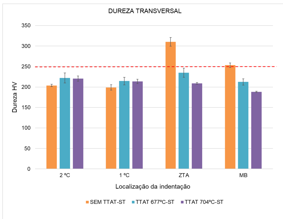
Figura 25 : Dureza transversal das amostras sem e com TTAT
