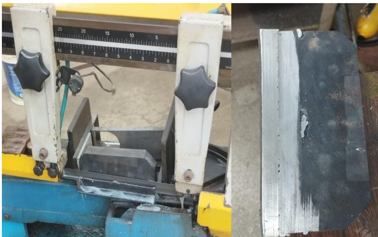
Figura 17 : Remoção das cantoneiras
