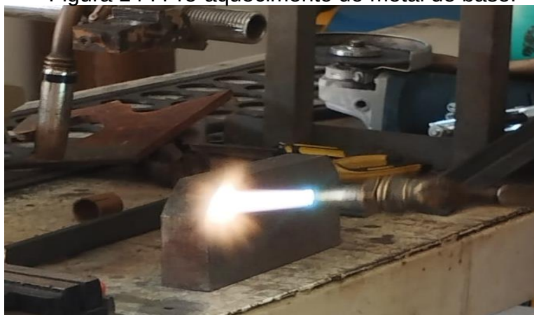
Figura 14 : Pré-aquecimento do metal de base.
