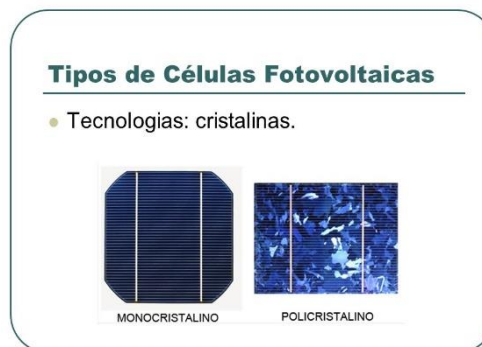
Figura 5: tipos de células fotovoltaicas Fonte: Solar panel
