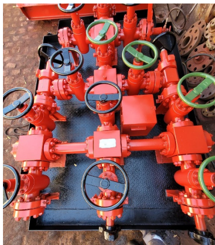
Figura 17 - Choke Manifold finalizado a pintura (Autoria Própria).
