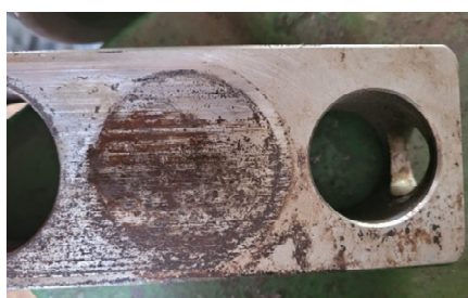
Figura 13- Obturador Gaveta antes da retificação (Autoria Própria).
