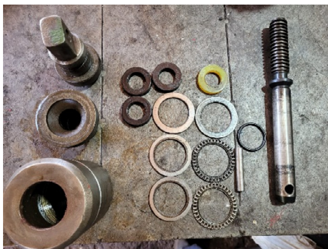
Figura 153 – Componentes do castelo de uma válvula gaveta (Autoria Própria).
