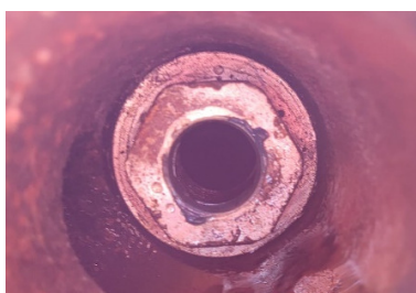
Figura 11- Sede da Válvula Bean (Autoria Própria).
