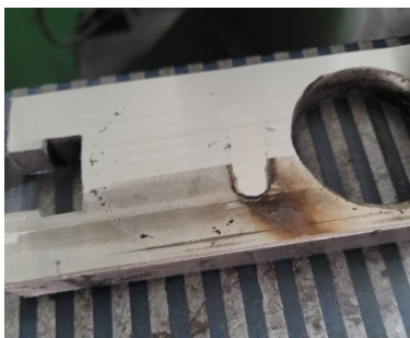
Figura 22- Obturador Gaveta em processo de retificação após soldagem (Autoria Própria).
