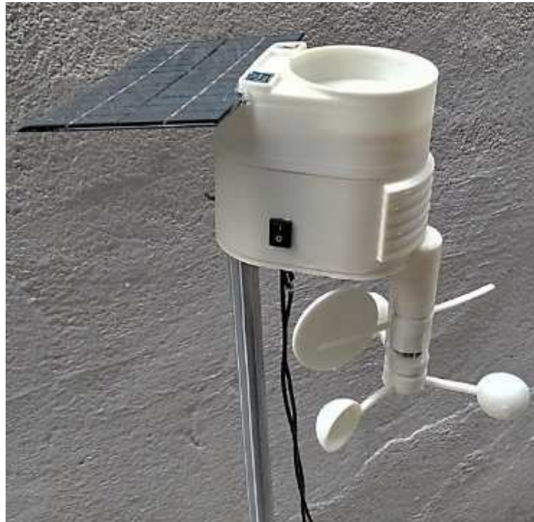
Figura 8 – Estação Meteorológica de baixo custo.
