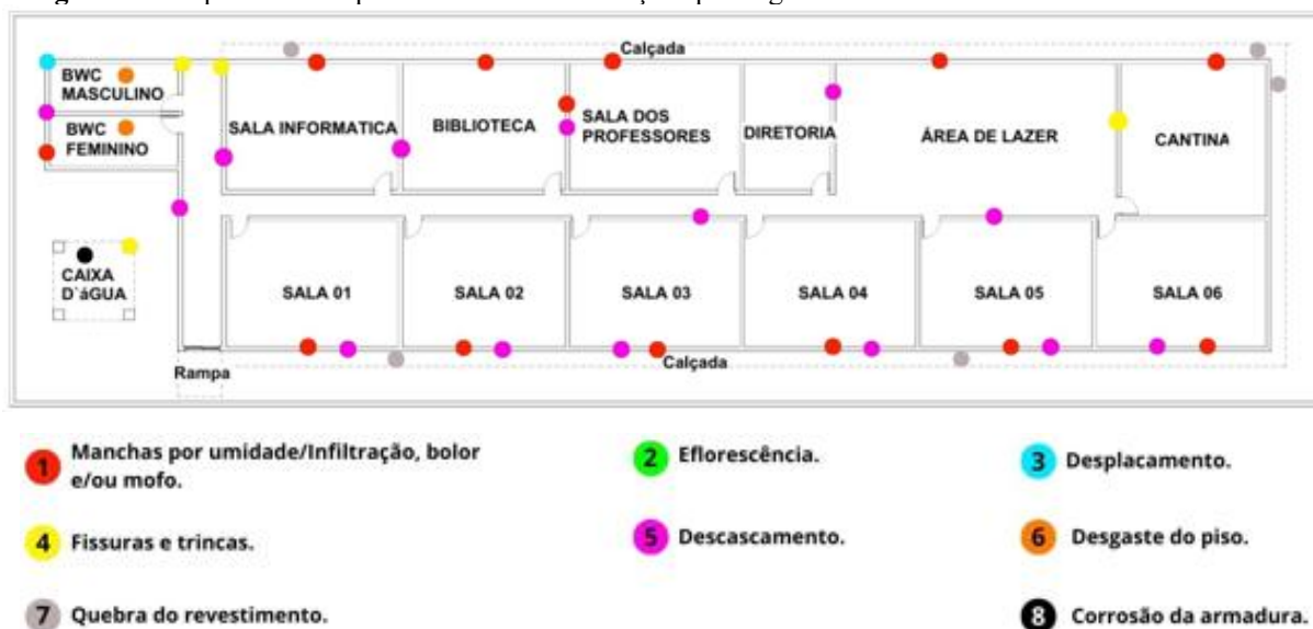
Figura 9: Croqui com o mapeamento das manifestações patológicas Centro de Ensino Estado de São Paulo.
