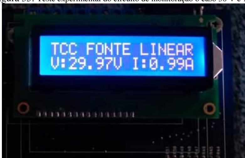
Figura 35: Teste experimental do circuito de monitoração o caso 30 V e 1 A.
