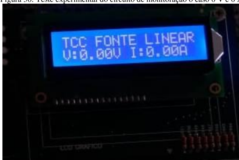
Figura 36: Teste experimental do circuito de monitoração o caso 0 V e 0 A.
