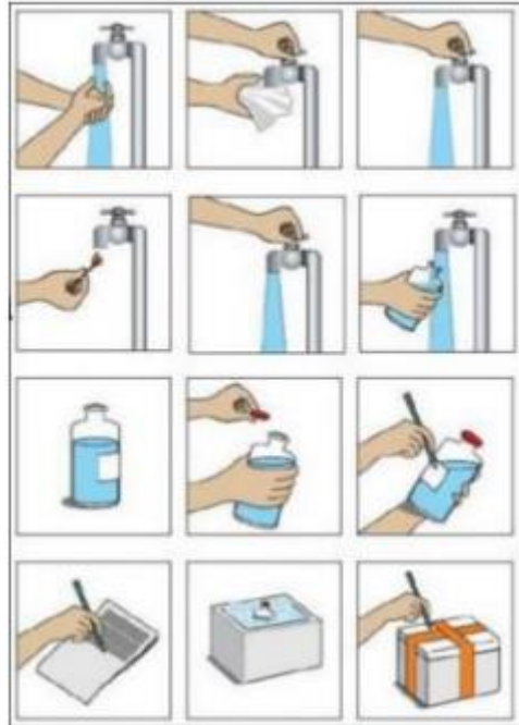
Figura 13 – Esquema ilustrativo do processo de coleta de amostras de água.
