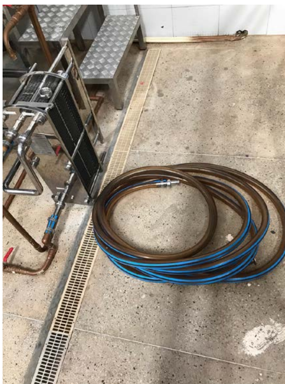
Figura 6 - Trocador de calor e mangueira usada na passagem do mosto
